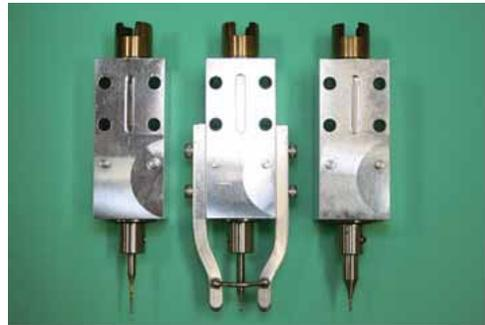
図8 スピンドルユニット（中央が改造品）
