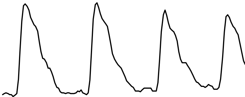
図2 光センサによって捕捉された脈波の例
