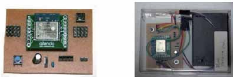
図1 IoT実習用基板と基板を使用した計測セット
