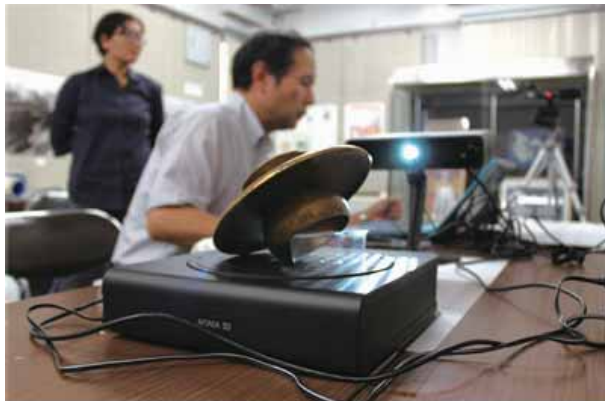
図4 3Dスキャナによる計測
